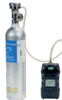
Ручная проверка с использованием поверочного газа
